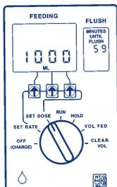
Permite limitar la dosis (de 1 a 1999 mL en los modelos A, B y C y de 1 a 9999 mL en los modelos D o más altos, en incrementos de 1 mL), oprimiendo las flechas del teclado. Al completarse la dosis se activará la alarma **DOSE COMPLETE (DOSIS COMPLETA)**. Ver la sección **DOSIS COMPLETA** (página 14). También podrá configurarse la DOSIS durante la fase de cebado automático.
