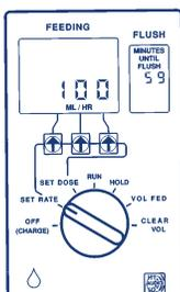
Permite establecer el índice de flujo (de 1 a 300 mL/hora en incrementos de 1 mL/hora), oprimiendo las flechas del teclado cuando la bomba esté en el modo **SET RATE (CONFIGURAR ÍNDICE)**. Podrá configurarse el índice durante o después de la fase de cebado automático.
