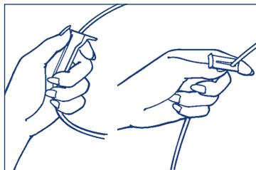
3. Conecte el juego de accesorios para la bomba Quantum de manera segura al recipiente de nutrición enteral lleno, si no estuviera ya conectado. Cuelgue el recipiente al lado o detrás de la bomba y a 20 pulgadas (50.8 cm) encima de la misma. Apriete la cámara visual para que quede de 1/3 a 1/2 llena.
