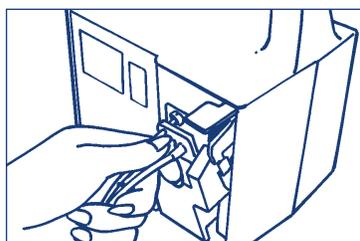
6. Abra el sujetador del juego de accesorios para alimentación (y deslice el sujetador de la bolsa de purga si se usa).
