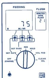
Es la única configuración que activará la alimentación. La pantalla visual mostrará el índice de flujo en mL/hora y una imagen en forma de gota se moverá a través de la parte inferior de la pantalla visual. Además, una luz verde pequeña en la esquina inferior izquierda de la bomba parpadeará cuando la bomba esté en el modo **RUN (FUNCIONAMIENTO)**.
